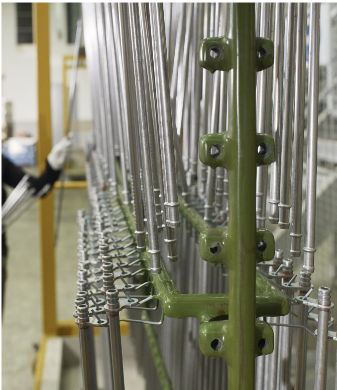
Gestell-Bestückung mit gestreckten Rohrleitungen
