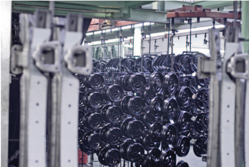
Beschichtete Teile in der KTL-Anlage. Das Lacksystem bietet insbesondere auf scharfen Kanten einen verbesserten Korrosionsschutz.
