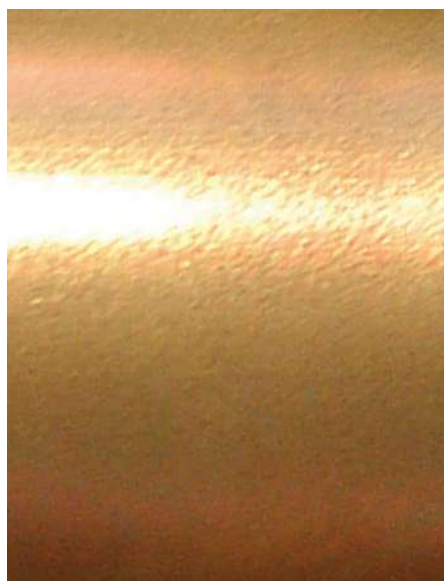
Bild 7: Nach dem Imprägnieren im Verfahren Sinter Surface Solutions hat das Sintermetallteil eine gleichmäßige, ebene Oberfläche.
