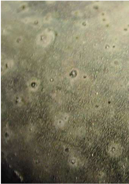
Bild 2: Stark salzhaltige Flüssigkeiten in den Poren metallischer Sinterteile führen nach dem Galvanisieren zum Bleed out. Es kommt lokal zu Schichtkorrosion.
